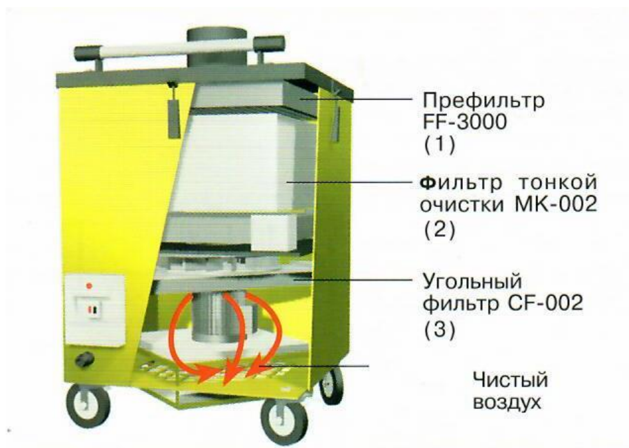
Рисунок 6.3 – Принцип работы фильтра
