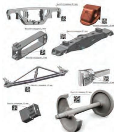
Рисунок 1 – Эскизы деталей, на которые необходимо наносить 2D маркировку с указанием мест и параметров ее нанесения
