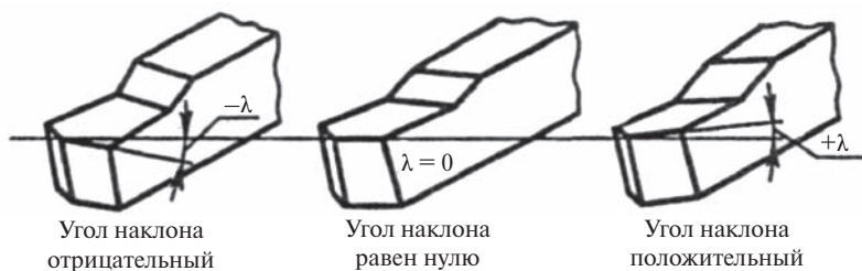
Рис. 8. Угол наклона главной режущей кромки
