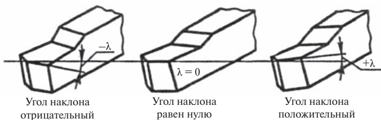
Рис. 8. Угол наклона главной режущей кромки
