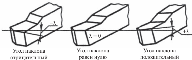
Рис. 8. Угол наклона главной режущей кромки
