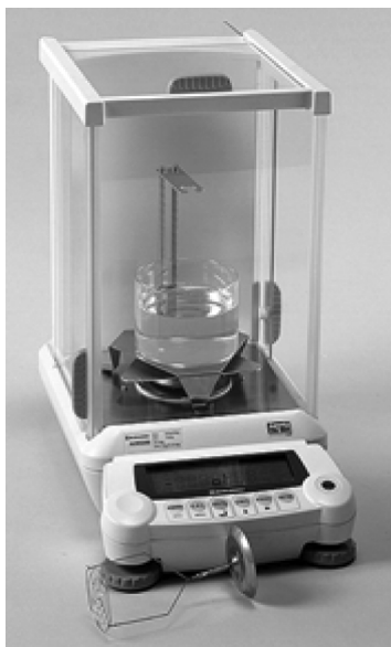
Рис. 5. Приборы для измерения плотности жидкостей: а — ареометр; б — гидростатические весы
