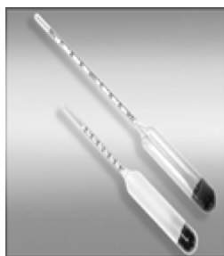
Рис. 5. Приборы для измерения плотности жидкостей: а — ареометр; б — гидростатические весы
