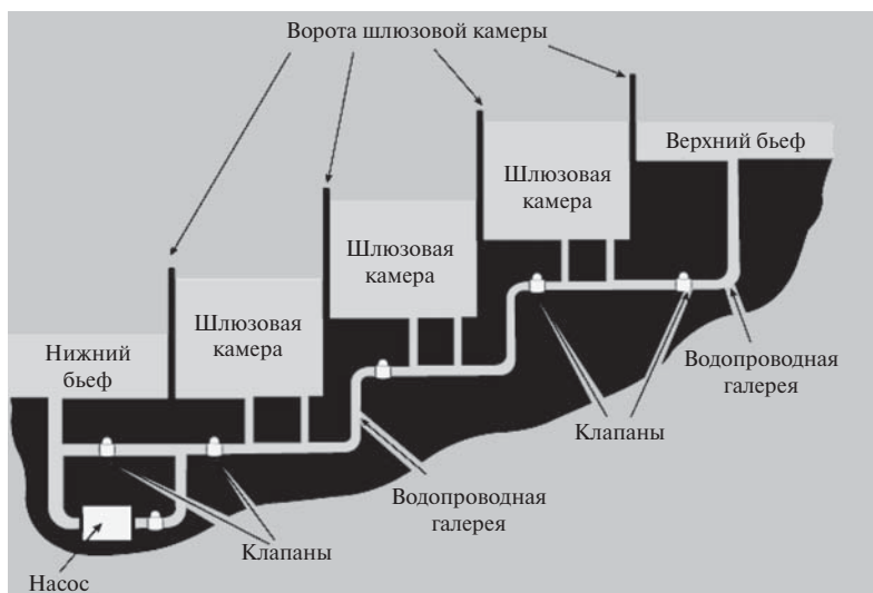
Рис. 2.11. Схема многоступенчатого шлюза
