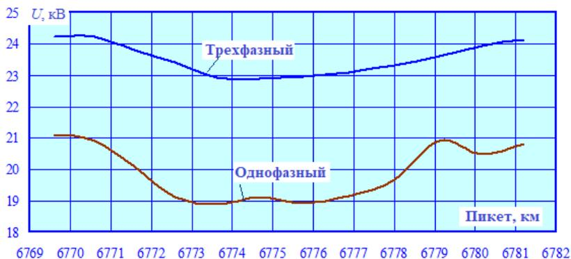
Рис. 5.32. Напряжение фазы четного поезда
