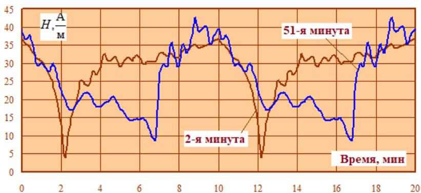
Рис. 6.29. Форма напряженности магнитного поля в точке с координатами (0 м; 1,8 м) для второй и 51-й минуты моделируемого времени
