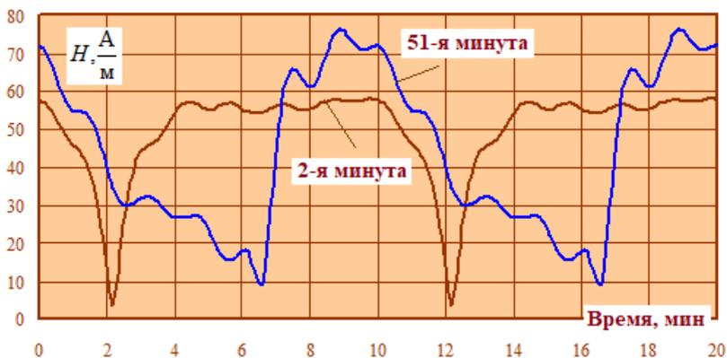
Рис. 6.21. Форма напряженности магнитного поля в точке с координатами (0 м; 1,8 м) для второй и 51-й минуты моделируемого времени
