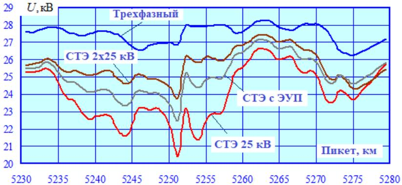
Рис. 5.22. Напряжения на токоприемнике первого нечетного поезда
