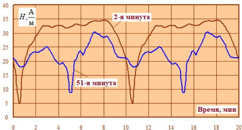
Рис. 6.25. Форма напряженности магнитного поля в точке с координатами (0 м; 1,8 м) для второй и 51-й минуты моделируемого времени
