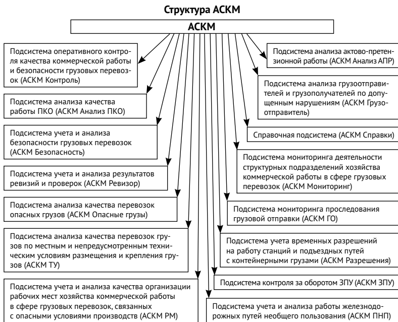
Рис. 8.3. Автоматизированная система оперативного контроля и анализа качества коммерческой работы и безопасности грузовых перевозок
