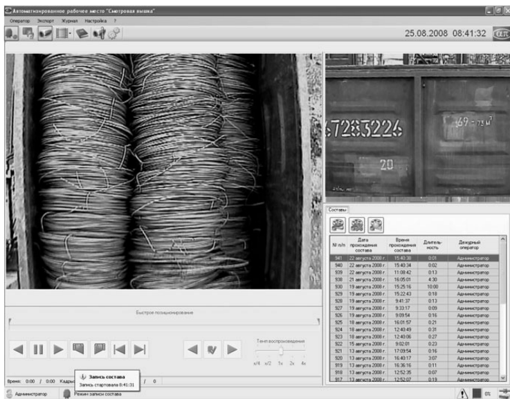
Рис. 8.17. Пример видеоизображения проходящего состава от боковой и верхней телекамеры
