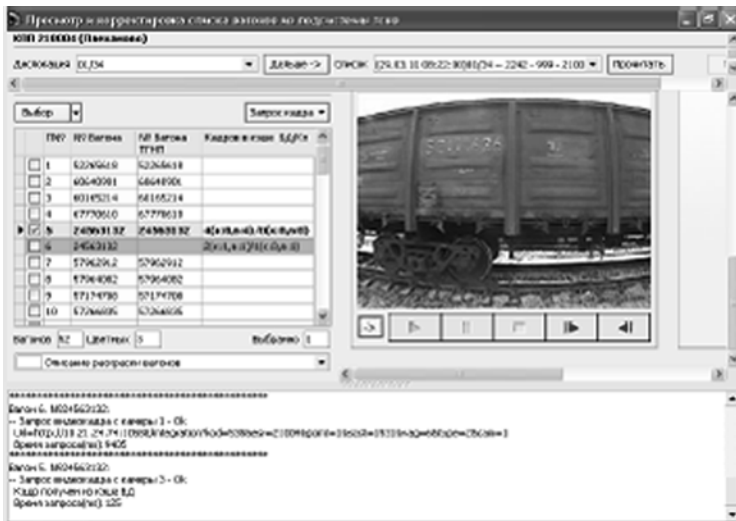
Рис. 8.13. Пример просмотра и корректировки списка вагонов
