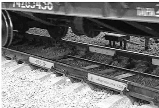
*Рис. 8.9. Весы вагонные тензометрические*
