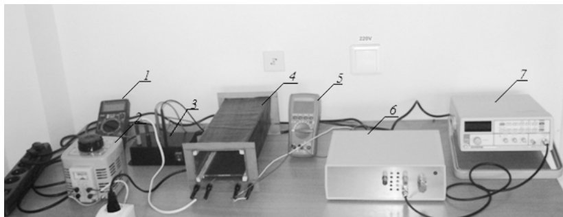
Рис. 1.11. Устройство для создания переменного магнитного и электрического полей 1 – вольтметр переменного напряжения; 2 – автотрансформатор; 3 – высоковольтный источник переменного напряжения; 4 – соленоид со встроенными металлическими пластинами; 5 – амперметр переменного тока; 6 – реостат регулировки тока (встроен в усилитель); 7 – генератор низкочастотный
