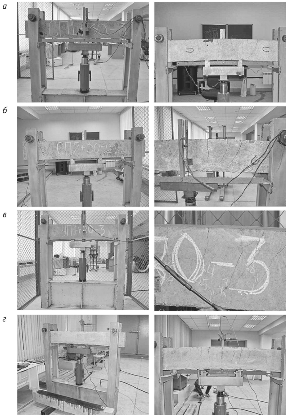
Рис. 4. Вид образцов до и после испытания на прочность: а — серия СП1; б — серия СП2; в — серия УП; г — серия А
