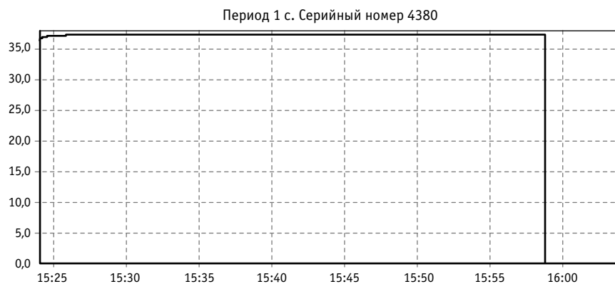
Рис. 6. Временная зависимость тока в цепи датчика с пороговой температурой 92 \pm 4 °С при изменении его температуры
