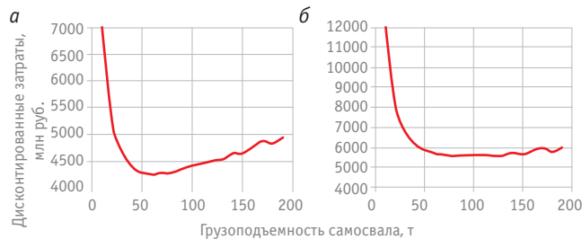
Рис. 3. Дисконтированные затраты на транспортирование горной массы в зависимости от грузоподъемности карьерных автосамосвалов (расстояние 20 км, объем перевозок 5 млн т/год):
