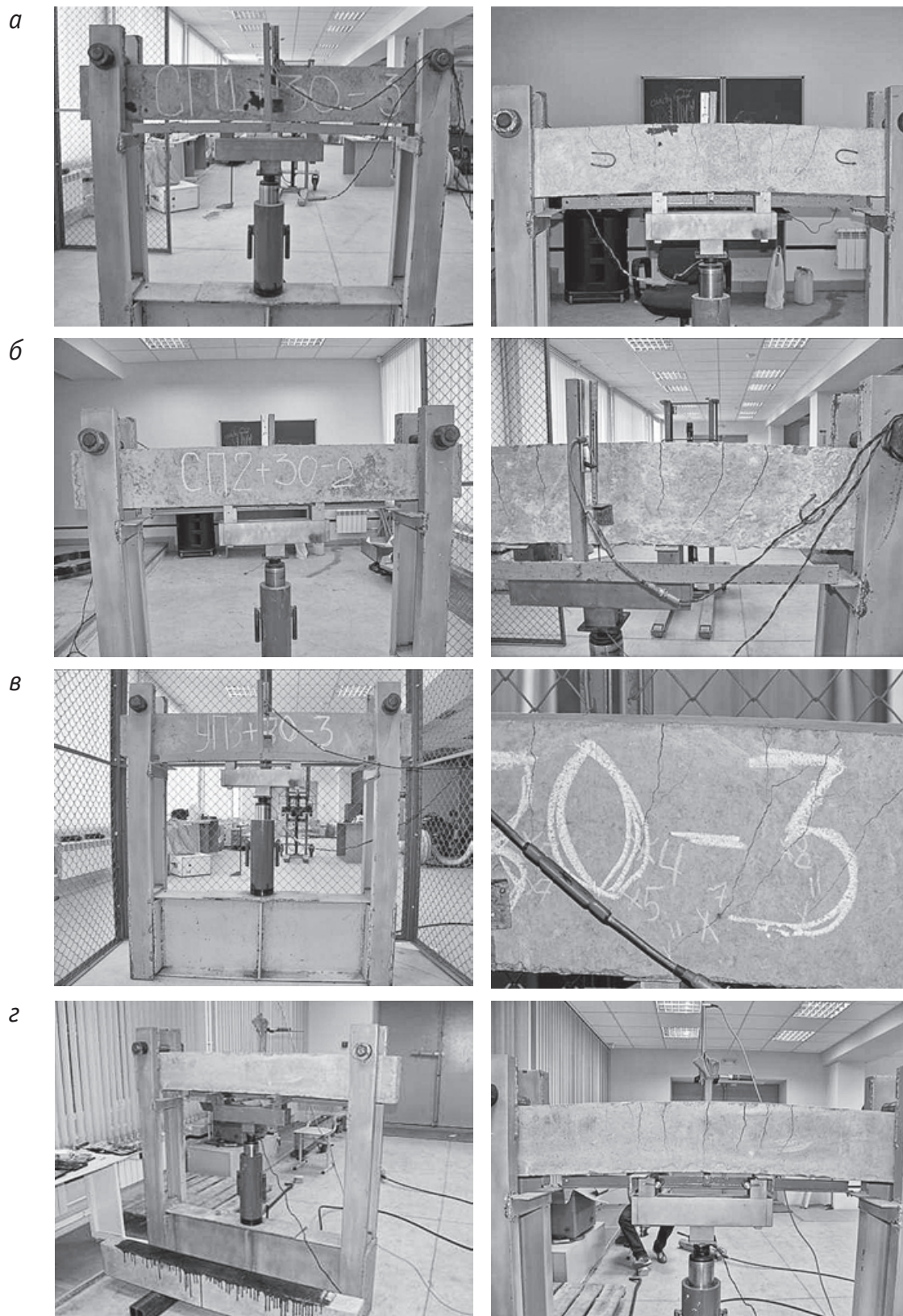
Рис. 4. Вид образцов до и после испытания на прочность: а — серия СП1; б — серия СП2; в — серия УП; г — серия А
