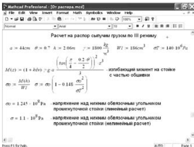
Рисунок 7 — Расчет от распора сыпучим грузом
