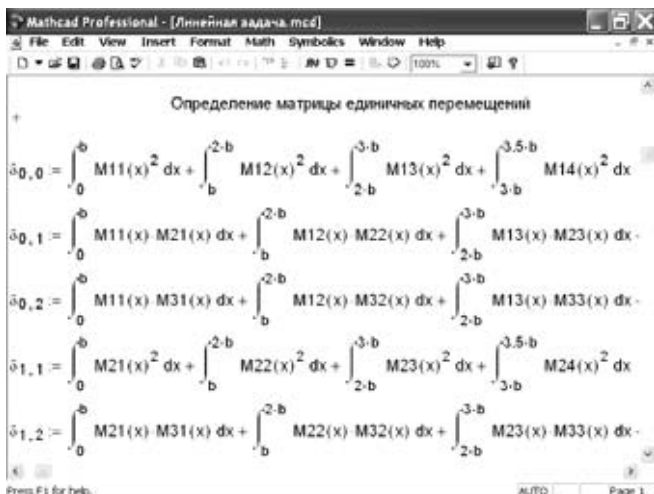
Рисунок 3 — Определение матрицы единичных перемещений
