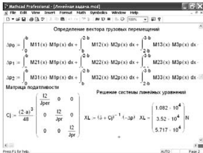
Рисунок 4 — Решение системы линейных уравнений
