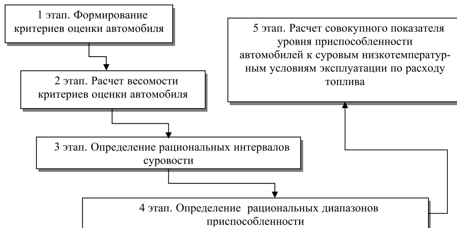
Рисунок 1 — Алгоритм оценки приспособленности автомобилей к суровым низкотемпературным условиям эксплуатации по расходу топлива
