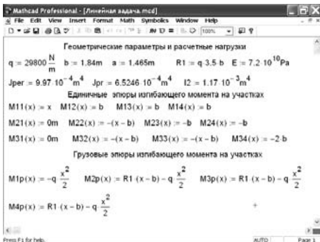
Рисунок 2 — Определение функций единичного момента
