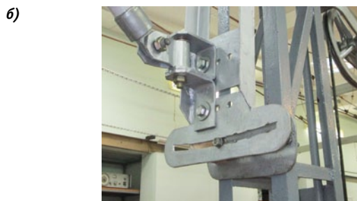
Рисунок 2 — Имитация наклона опоры параллельно (а) и перпендикулярно (б) оси пути
