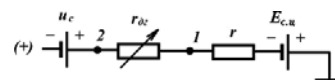
Рисунок 5 — Эквивалентная схема цепи при расположении отключающего контактора в схеме со стороны токоприемника
