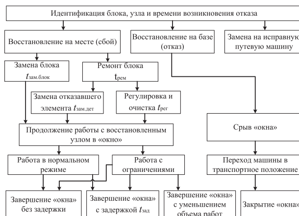
Рисунок 9 — Схема развития отказа и его влияния на реализацию технологического процесса
