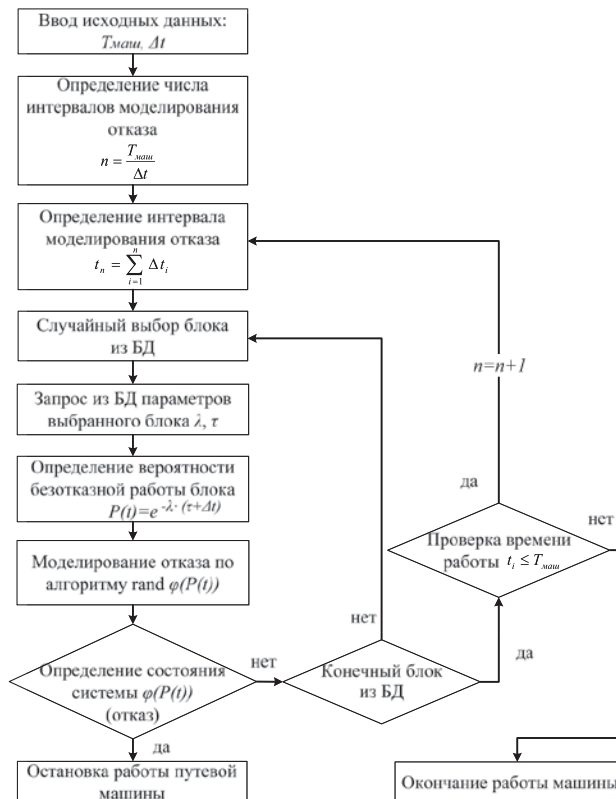
Рисунок 7 — Алгоритм моделирования отказов путевых машин
