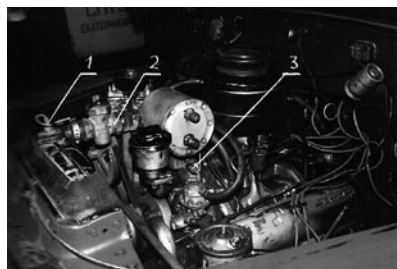
Рисунок 2 — Общий вид моторного отделения автоцистерны АЦ-40(130): 1, 3 — датчики температуры охлаждающей жидкости соответственно в верхней бачке радиатора и до термостата; 2 — пробковый кран D,40
