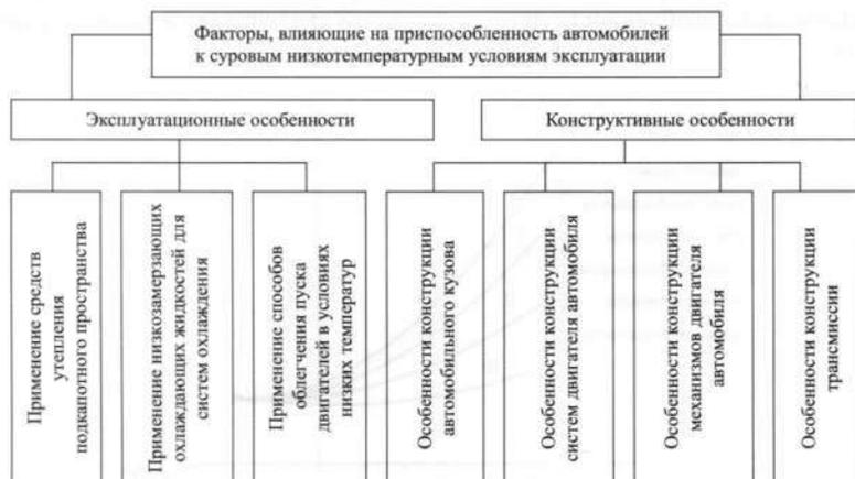
Рисунок 2 – Классификация факторов, влияющих на приспособленность автомобилей к суровым низкотемпературным условиям эксплуатации
