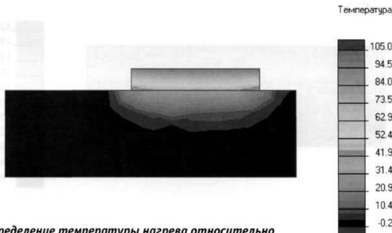
**Рисунок 9** — Распределение температуры нагрева относительно окружающей среды в подшипниковом кольце и вале
