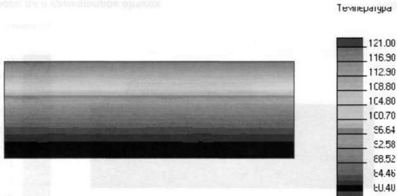
Рисунок 6 – Распределение температуры в подшипниковом кольце (без вала)
