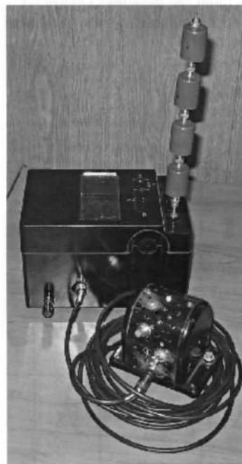
Рисунок 1 – Внешний вид устройства контроля частичных разрядов
