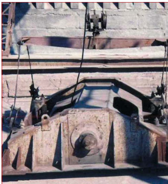
Рис. 2. Накладной вибратор Урал-ЦНИИ-МПС
