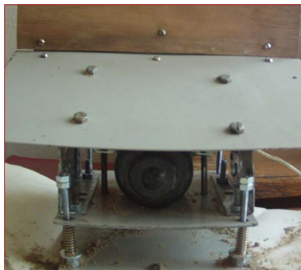
Рис. 4. Вибрационный стенд, имитирующий разгрузку надтележечного люка полувагона накладным вибратором
