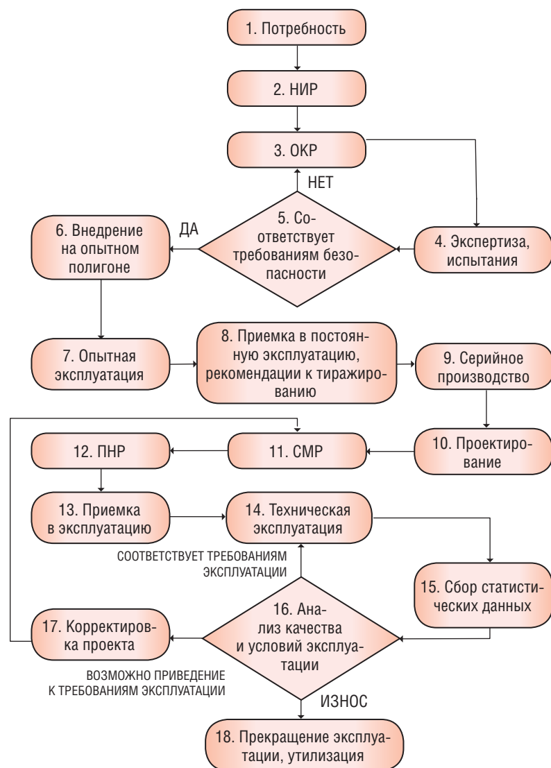
Рис. 1. Жизненный цикл устройств ЖАТ
