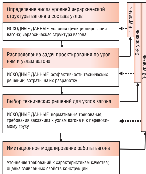
Рис. 5. Блок-схема — алгоритм итерационного процесса проектирования
