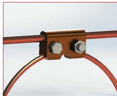
Рис. 1. Струновой зажим, построенный в среде SolidWorks
