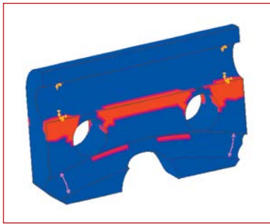
Рис. 3. Результаты испытаний (разрушение детали)
