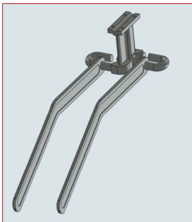
Рис. 6. Узел крепления дополнительного стержня фиксатора контактного провода
