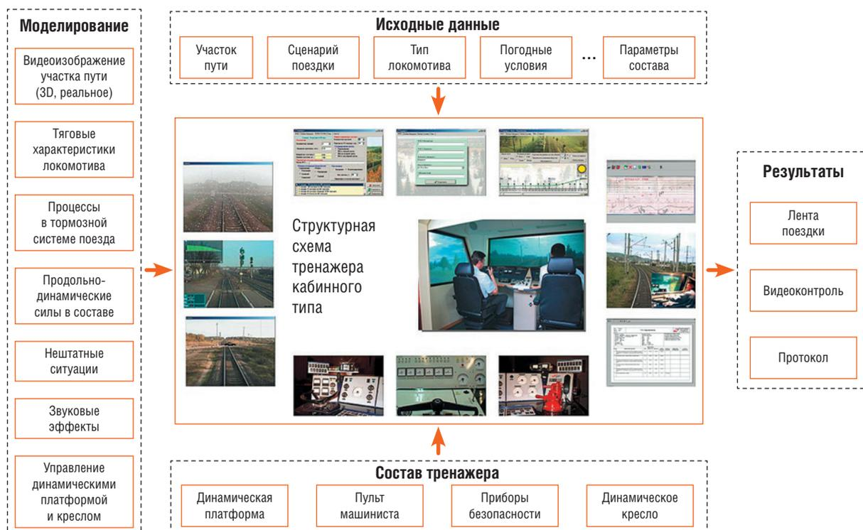
Рис. 2. Структурная схема тренажера кабинного типа
