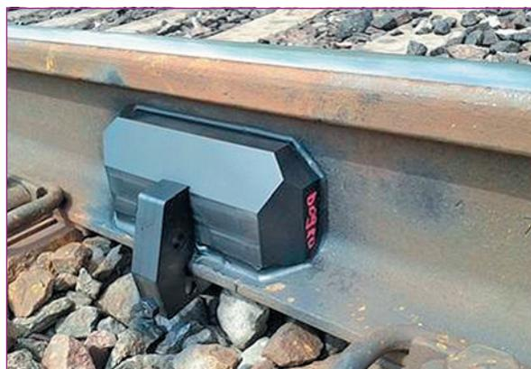
Рис. 5. Система контроля напряженного состояния рельсовых плетей СКБП-2009
