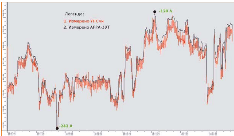
Рис. 4. Результаты измерений тока в обратной тяговой сети токовыми клещами и УНС4и
