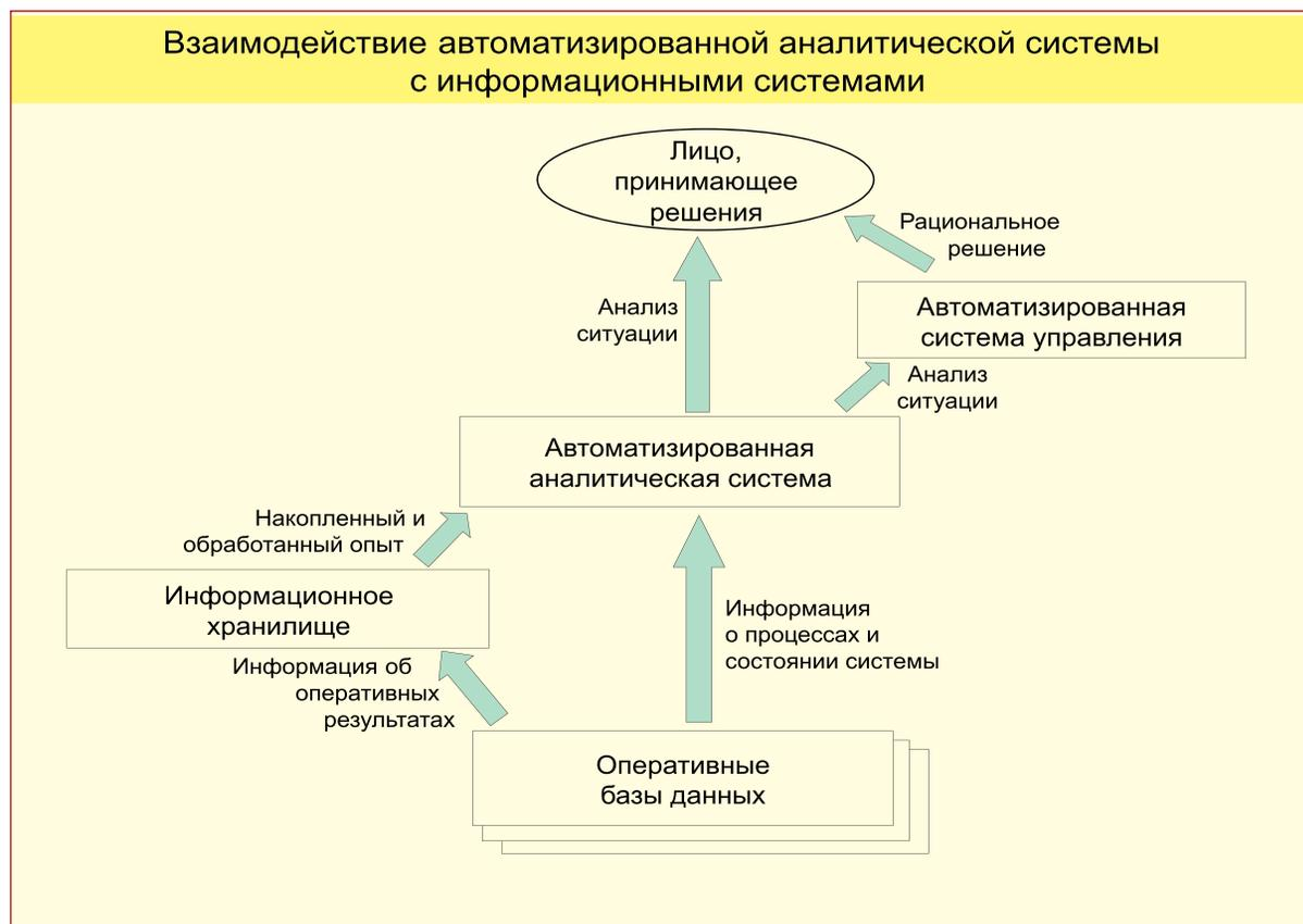
Рис. 1. Взаимодействие автоматизированной аналитической системы с информационными системами
