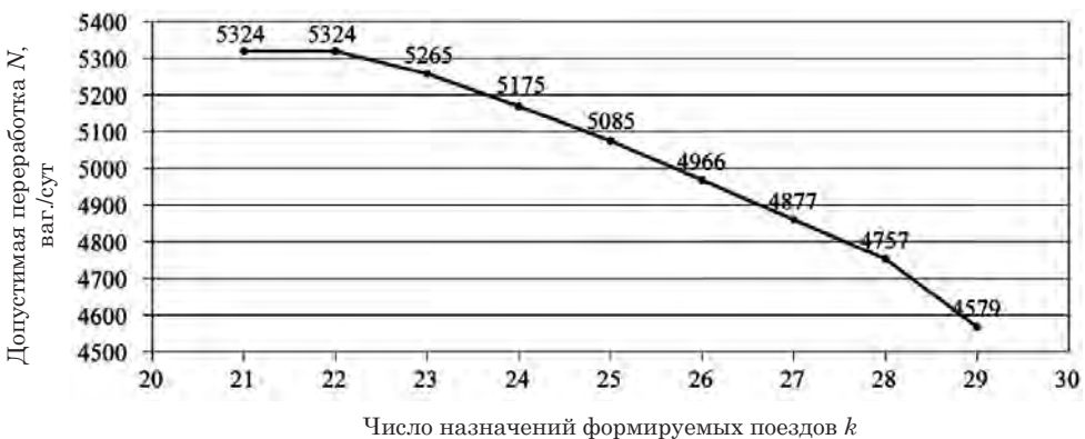
Рис. 1. Зависимость допустимой переработки от числа назначений. Станция Инская, нечетная система («Схема размещения и программа совершенствования работы и развития сортировочных станций ОАО «РЖД» на 2016–2025 гг.» (информация за 2012 г.)) [4]
