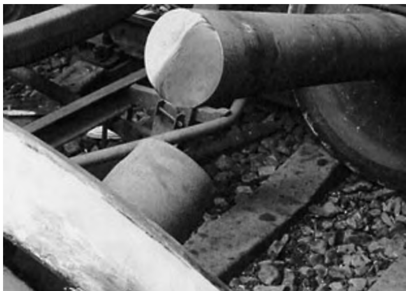
Рис. 1. Излом оси колесной пары грузового вагона
